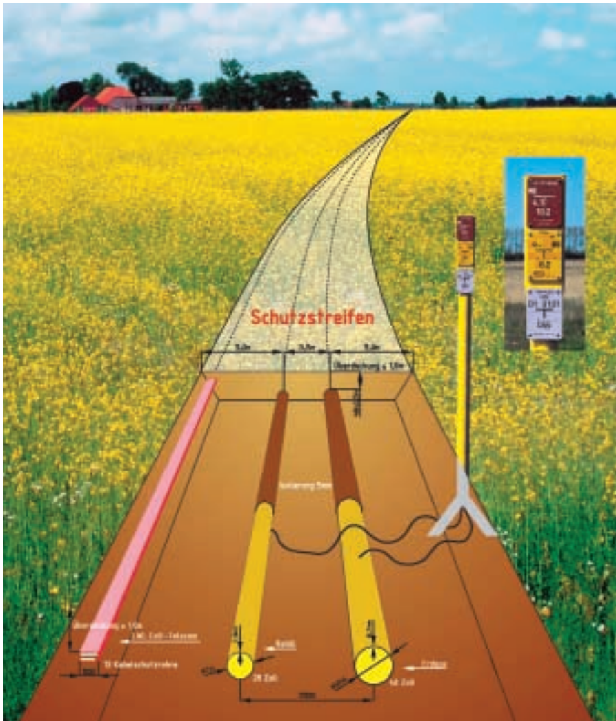
Beispiel einer Trassenführung und Anordnung von Fernleitungen
